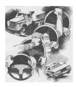
Высокая скорость руления двумя руками — это гарантия вашей безопасности при заносе и вращении автомобиля и возможности скомпенсировать допущенную вами ошибку, следствием которой стала потеря устойчивости автомобиля. Самый "быстрый" способ — это руление на боковом секторе рулевого колеса с перекрестным захватами.
