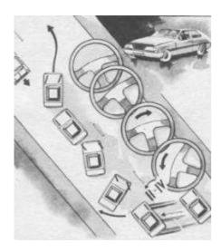
Если мощность двигателя утеряна во время экстренного маневра, торможения или борьбы за устойчивость автомобиля, а ситуация остается опасной, верните автомобилю максимальную мощность быстрым включением понижающей передачи, пропуская обычную последовательность, например с IV передачи перейдите сразу на II.
